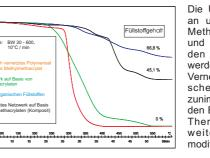
Die Untersuchungen erfolgten an unterschiedlich vernetzten Methacrylat-Komposites mit und ohne Füllstoffanteil. Aus den Kurven kann ermittelt werden, dass mit steigendem Vernetzungsgrad die thermische Stabilität tendenziell zunimmt. Zusätzlich kann durch den Einsatz von Füllstoffen die Thermostabilität für einen weiten Gebrauchsbereich modifiziert werden.
